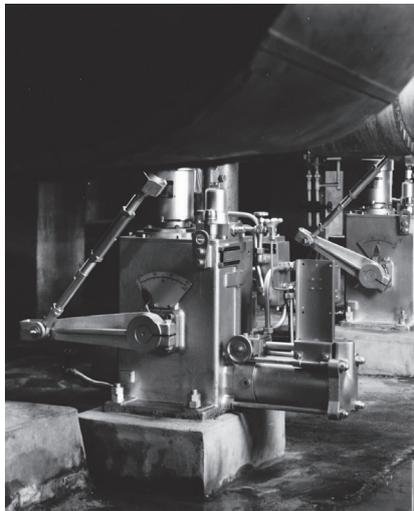
写真 1-5 焼却炉に計装したパワーバック
