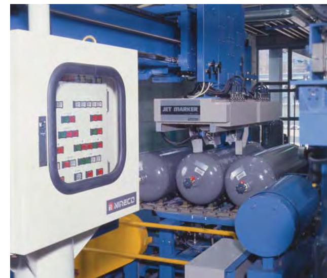
用喷墨式印字机在丙烷储气瓶上印字时
