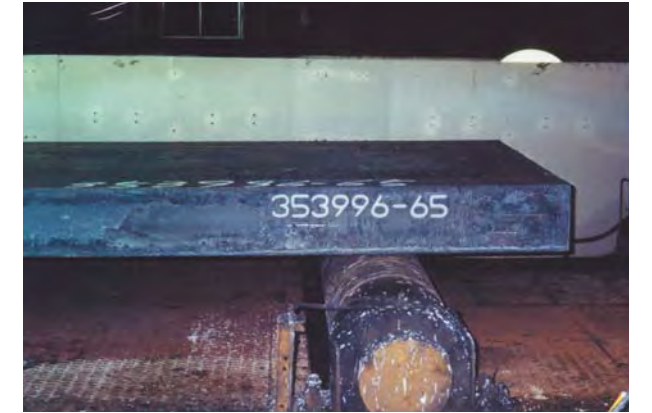
用喷墨式印字机在 600°C~1000°C 的板坯侧面印字例
