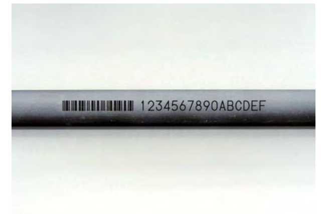
用激光式印字机在钢管上的条码及数字印字例
