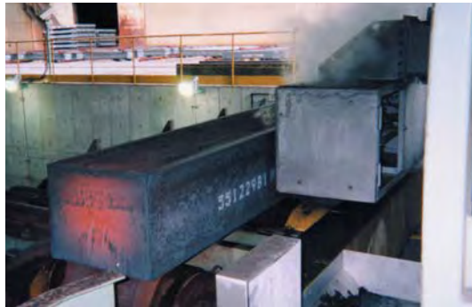
在钢锭上进行点阵印字例
