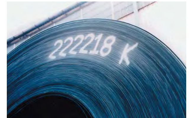
用喷墨式印字机在 600°C~800°C 的热轧卷材的侧面印字例
