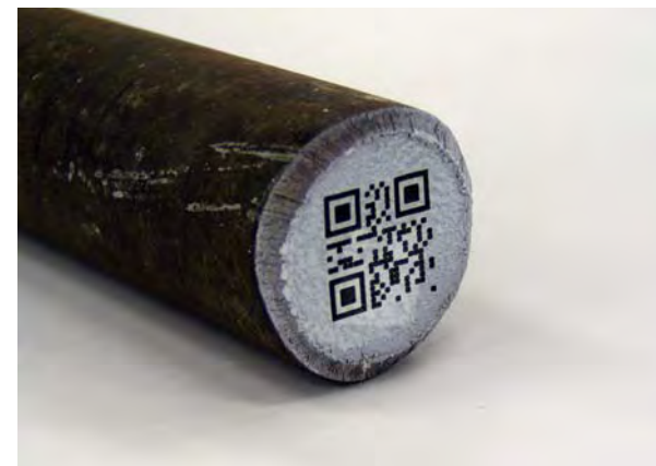
用激光式印字机在棒钢端面的二元代码印字例
