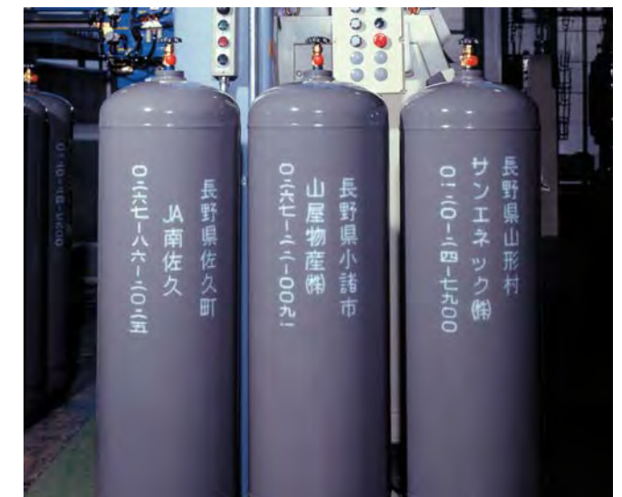
用左边装置印字的实例。正在识别不同的交货对象进行印字。 (也适用于中国字、韩国字、特殊字符)
