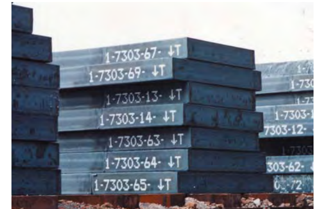
用点阵式印字机在 300°C~1000°C 的板坯侧面印字例
