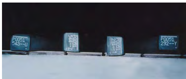
对纵横交错叠放的钢坯，也能用同一个印字头印字
