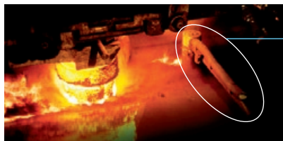
連続鑄造機での渦流式溶鋼レベル計
