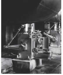
写真 1-5 焼却炉に計装したパワーパック
