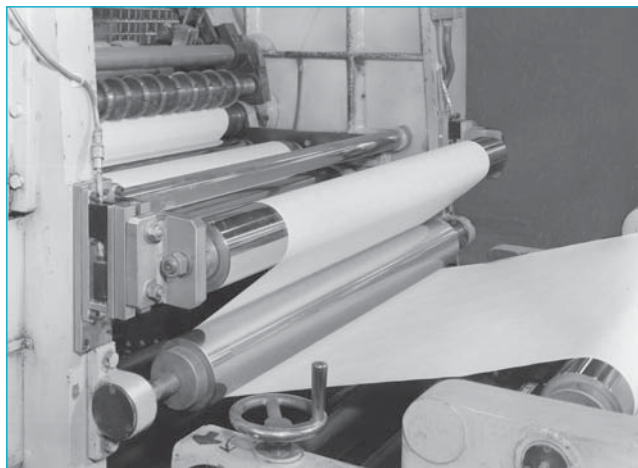
MB 张力传感器安装实例
